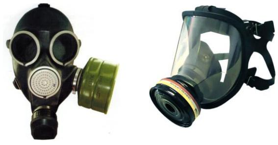
Лицевая часть бывает трех ростов (1;2;3). Для подбора лицевой части необходимо определить замер вертикального (замкнутая линия, проходящая через макушку, щеки и подбородок) и горизонтального (замкнутая линия, проходящая через лоб, виски и затылок) обхвата головы. Результаты округляют до 0,5 см.
